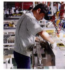
組立ブースで昇降機のドア開閉装置を組み立てる
