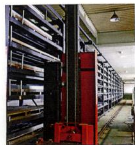
3台のパンチングマシンが繋がる自動倉庫MARS(7段18列)
