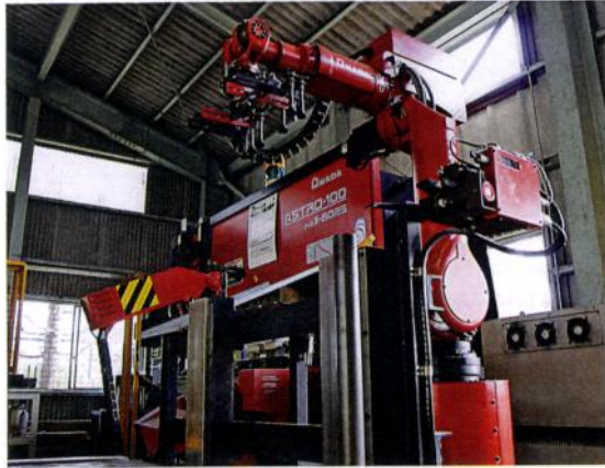
単純曲げで数の多い製品に特化し、作業者の負担を軽減するASTRO-100NT
