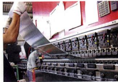
パンチングマシンによるR曲げ。3本ロールによるR曲げ加工にも対応する
