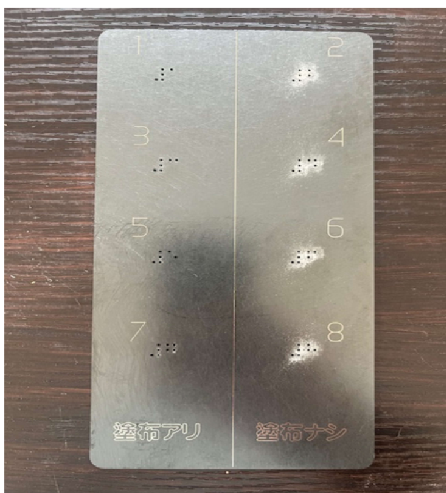
○レーザピアッシング加工時のスパッタ (材料 SUS304 ブラック)
